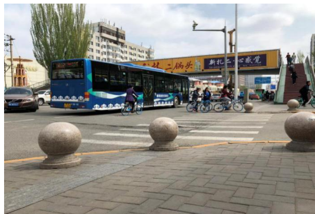
图 1-1-2 内蒙古大学校园门口路段盲道被石墩拦截（图片来源：作者自摄）
